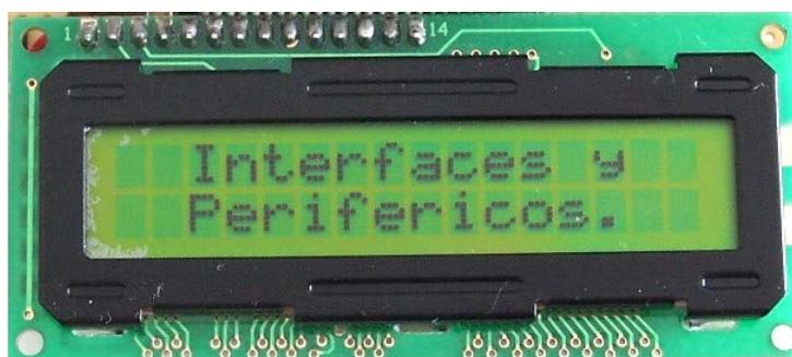
**Figura 1** Vista frontal de un LCD alfanumérico
